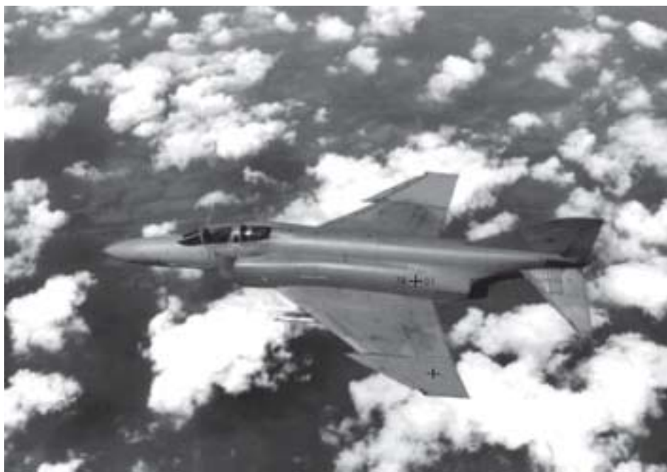
Die F-4 F Phantom II, ein schweres Jagd- und Jagdbomberflugzeug, ist seit den sechziger Jahren im Einsatz und wird in vielen Ländern weiterhin modernisiert. Die Bundeswehr wird diesen Typ schrittweise durch den Eurofighter Typhoon ersetzen. Ausrangierte Phantom II werden zu Zieldrohnen umgebaut. Quelle: Bildstelle des BMVg
